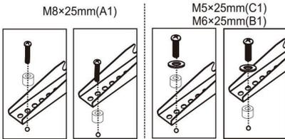
**警告** ネジの長さが長すぎるとディスプレイ機器を破損するため、これを防ぐためにスペーサーを使用する必要があります。
