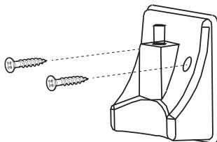
**5** 収納用パーツの位置、がたつき等を確認し、ネジで確実に取り付けます。
