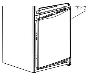
④下ドアのキャップは、ドアの反対側に取り付けます。
