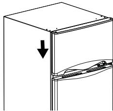
①中央部ヒンジに合わせて上ドアを取り付け、上ドアを閉めた状態にします。
