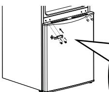
②中央部ヒンジを左側に取り付けます。キャップを右側に取り付けます。
