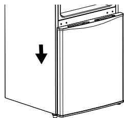
①本体を起こし、下部ヒンジに合わせて下ドアを取り付け、下ドアを閉めた状態にします。
