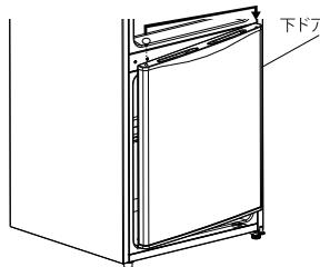
④下ドアのキャップは、ドアの反対側に取り付けます。
