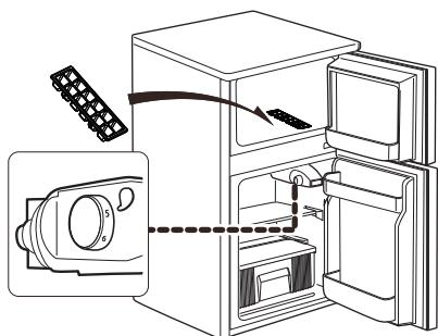
※温度調節ダイヤルを長時間「5~6」に設定しないでください。製氷後は必ずもとの位置に戻してください。
