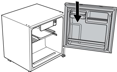
⑤本体上部のヒンジカバー、ヒンジ、ネジ、ネジ穴カバーを取り付ける
