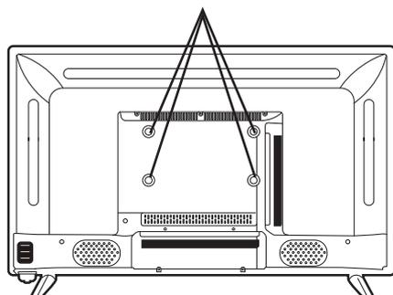
壁掛け金具取り付け寸法：200mm×100mm
