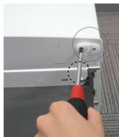
②プラスドライバーを使って、下部ドア底面左側にヒンジ受けを取り付けます。
