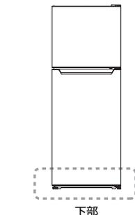
①プラスドライバーを使って、下部ドア底面右側のヒンジ受けを外します。
