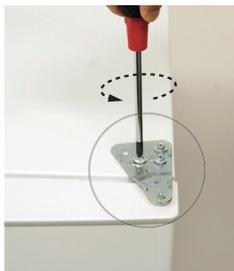
③マイナスドライバーを使って、ヒンジ穴カバーを外します。
