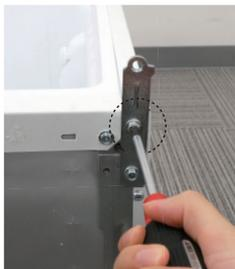
④下部左側、調整脚(大)を回して外します。
