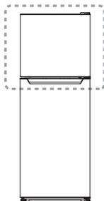
①マイナスドライバーを下図の囲い部に差し込み、ヒンジカバーを持ち上げて外します。
