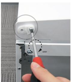
③下部左側にプラスドライバーを使って2本のネジを締め、下部ヒンジを取り付けます。
