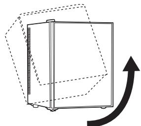
②本体底部のヒンジ、ネジ、調節脚をはずす
