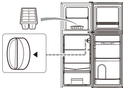
※温度調節ダイヤルを長時間「6～7」に設定しないでください。製氷後は必ずもとの位置に戻してください。
