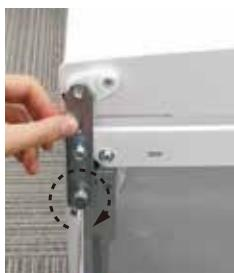
④調整脚（小）を回して取り付けます。
