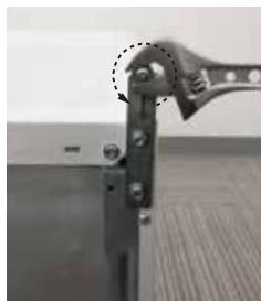
③プラスドライバーでネジを2本外し、下部ヒンジを取り外します。
