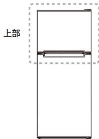
①マイナスドライバーを下図の囲い部に差し込み、ヒンジカバーを持ち上げて外します。
