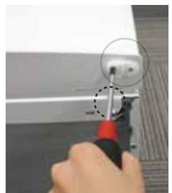
②プラスドライバーを使って、下部ドア底面左側にヒンジ受けを取り付けます。
