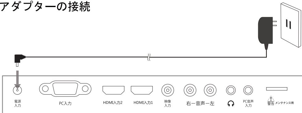
付属のACアダプターを本体背面の電源端子とコンセントに接続します。
