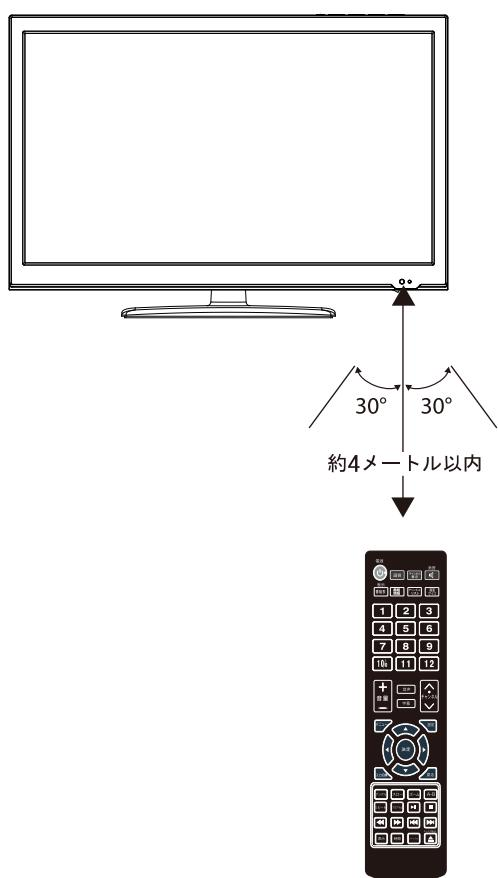
リモコン使用時はリモコン赤外線発射口を機器フロントパネルの受光部へ向けてください。
