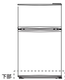
①下部右側、調整脚（小）を回して外します。
