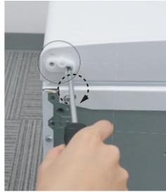
②下部左側にプラスドライバーを使って2本のネジを締め、下部ヒンジを取り付けます。
