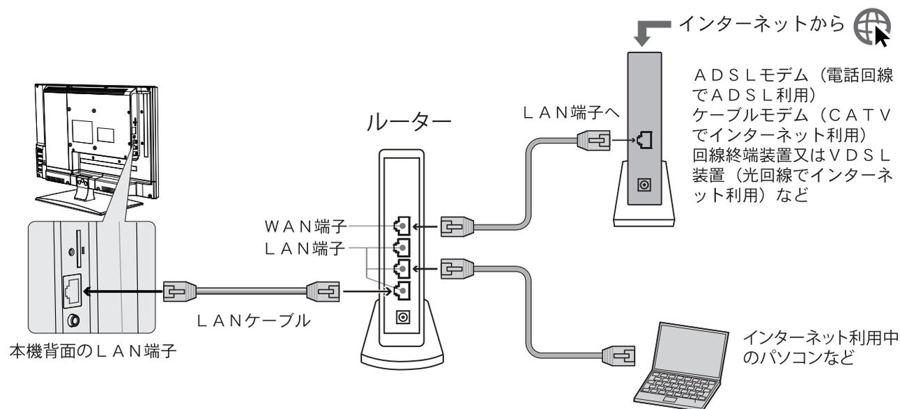
**ご注意：**LANケーブルを抜き差しする場合、本機と接続機器の電源を切ってから、電源プラグをコンセントから抜いてください。
